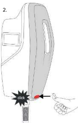
Fig. 22: Colocación de la cubierta frontal - 2
